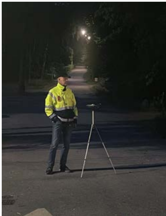
Arbetsmiljöingenjör Tomas Rosenblad genomför en mätning under tystnad. Till och med ett skrap med foten kan störa mätningen.
